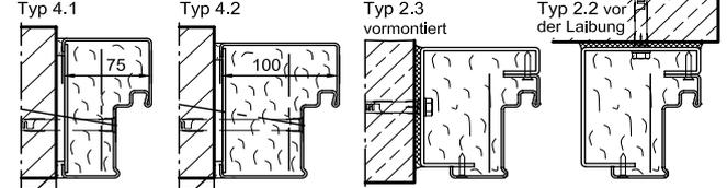
**Einbau in Porenbetonwänden (Türen mit OTS)**
