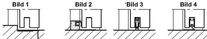
**Einbau in Mauerwerk-/Betonwänden**
