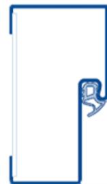
Blockzarge für den Einbau in der Öffnung
