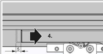
Damit die Dämpfer nicht unter Dauerspannung stehen, müssen diese 5 mm aus der Endlage geschoben werden. Die Lebensdauer der Dämpfer wird verlängert.
