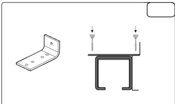
1. Montieren Sie den Tunnel der verstellbaren Zarge gemäß der in der Verpackung enthaltenen Montageanleitung - optional (Abb. 1).
