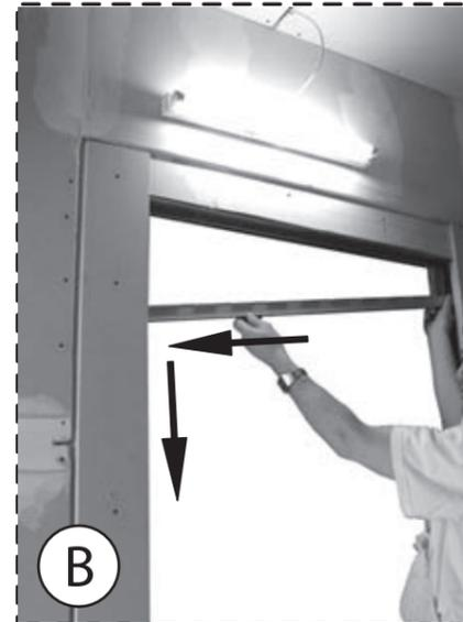
B) ...und ziehen Sie die Laufschiene nach vorne. Die Laufschiene fällt im Schubkasten aus Ihrer Verzahnung.
