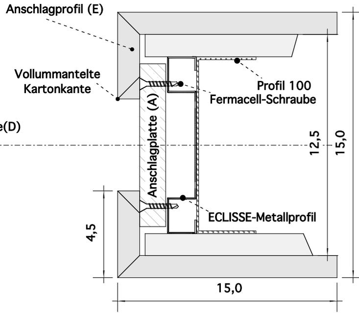
**1** Bodenführung montieren.
