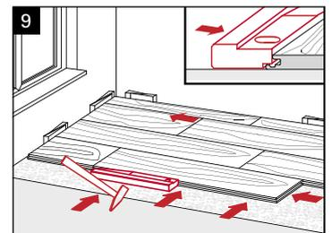
Der Boden ist sofort nach der Verlegung bezugsfertig. Sie müssen nur noch die Kunststoff-Rastkeile entfernen und Parador Sockelleisten mit Cliptechnik oder mittels Parador Montagekleber anbringen.
