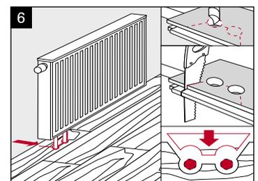
Bei Vinyl mit SPC-Trägerplatte, Vinyl aus Vollmaterial, Vinyl zum Verkleben und Modular ONE Hydron ist es ausreichend, die Rohraussparung wie oben beschrieben zu bohren und von der Aussparung mit einem Cuttermesser zum Dielenrand zu schneiden. Anschließend können Sie die Diele auseinanderbiegen, um das Rohr legen und wieder zurückbiegen (Bild 7).
