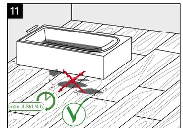
Vinyl mit HDF-Trägerplatte darf nicht in Bereichen verlegt werden, in denen Spritzwasser auf den Boden gelangen kann (Bild 12). Stehendes Wasser dringt über die Kanten in den HDF-Trägerplattenkern ein und beschädigt ihn dauerhaft.
