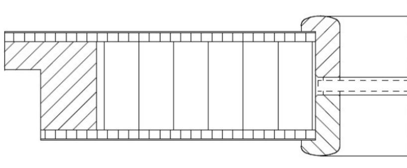
Querschnitt Vollspanplatte mit Glaseinsatz
