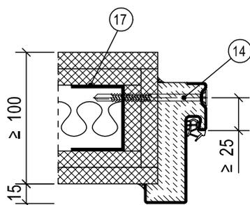
**X-Maß:** Mauerwerk, Beton  $\geq 50,0$  mm / Porenbeton T30, T90  $\geq 87,5$  mm / Porenbeton T30, RS  $\geq 57,5$  mm bis 100 kg Türgewicht / Porenbeton RS  $\geq 75,0$  mm
