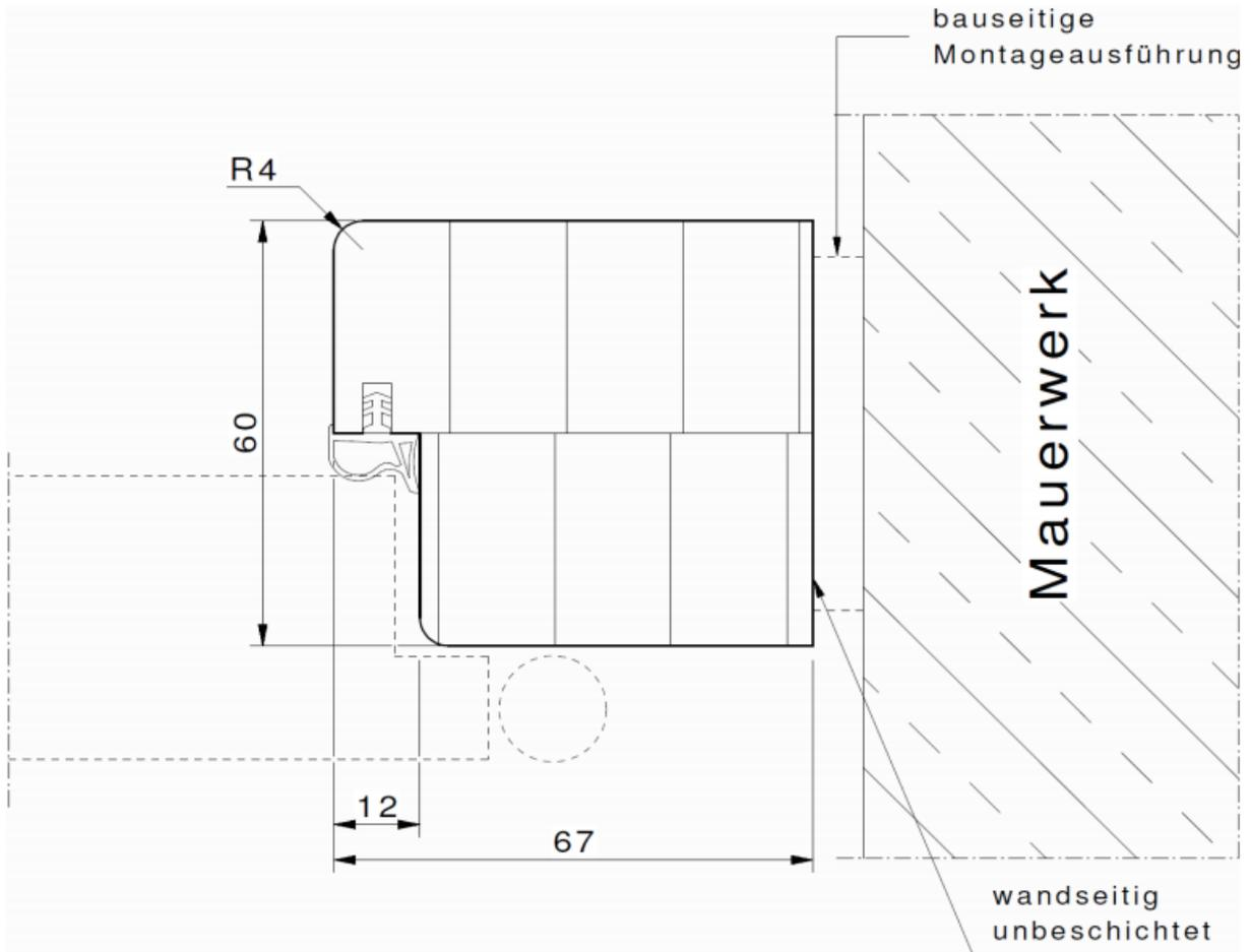
Anmerkung zur Montage: Der verbleibende Luftspalt zwischen Blockrahmen und Mauerwerk muss bauseitig ausgefüllt / abgedeckt werden.
