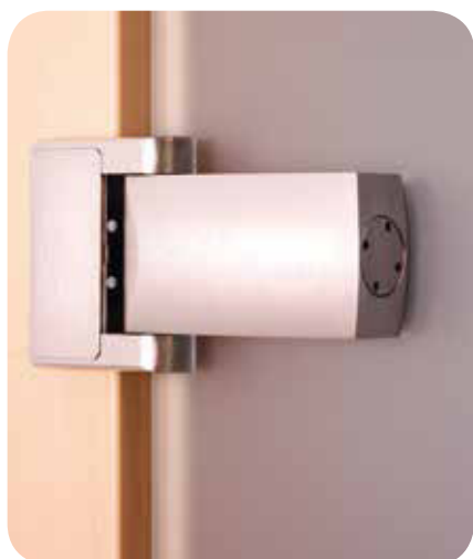
V-808 Hydraulik-Pendeltürband für Zargenmontage in Holz- oder Stahlzarge Feststellung 90° einseitig regulierbare Schließgeschwindigkeit
